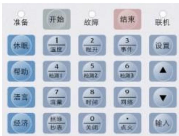
变压器油色谱仪的操作键盘共 22 个操作按键以及 3 个状态指示灯：
