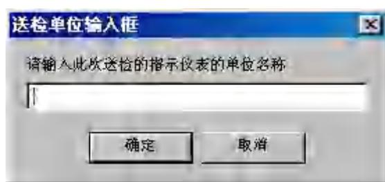
输入完送检单位并按下“确认”按钮后，系统会自动将多功能校验仪存储的检定数据存入控制系统的数据库中，方便以后管理。
