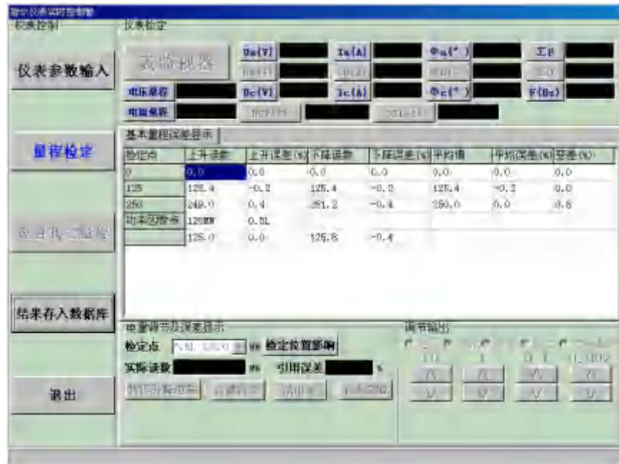
只需点按“检定位置影响”按钮，系统会在窗口底部显示“检定位置影响”检定框并在中部显示“位置影响实际值显示”框，如下图所示：
