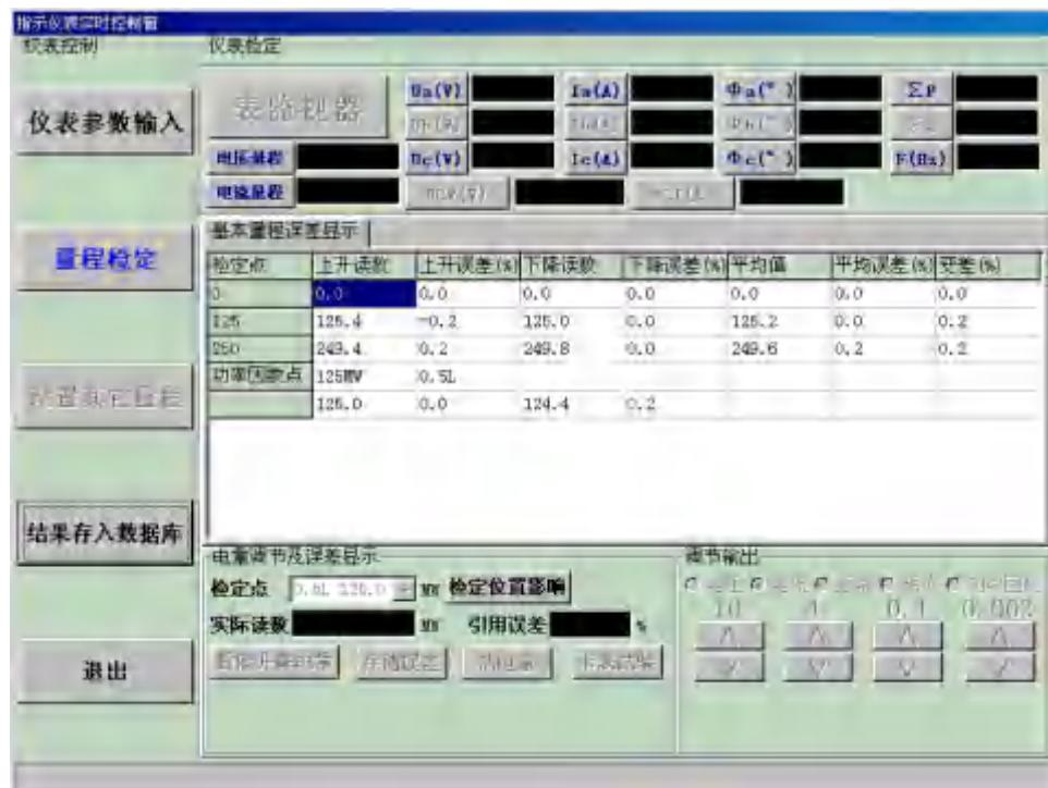
如果您正在检定一块多量程的仪表（注意：多量程仪表的引用值的单位应该选择“格”，才可设置其它量程），则可点按“校表控制”框中的“设置其它量程”按钮，系统会转到“其它量程设置”窗中，检定点会按照规程自动将零点、最大误差所在点及引用值所在的检定点填入第一、二、三检定点，如下图所示：
