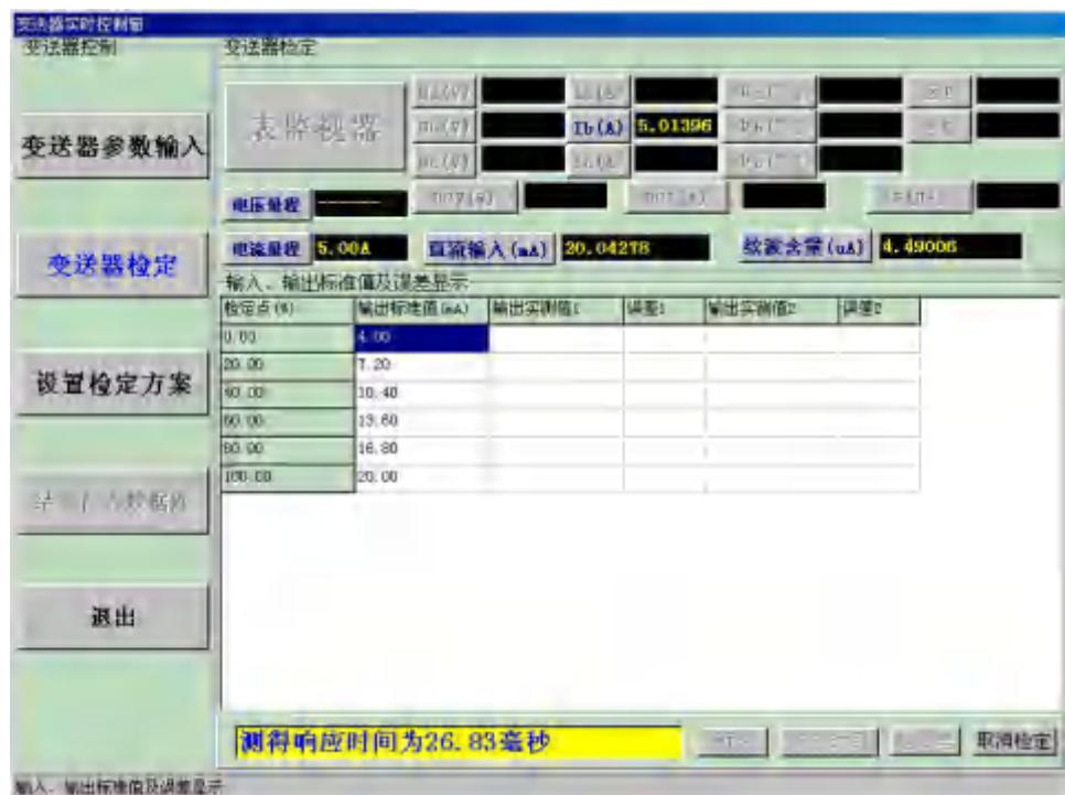
接着便会自动检定第一个检定点，将电量升到适当的值，并随时更新测量值，如下图所示：
