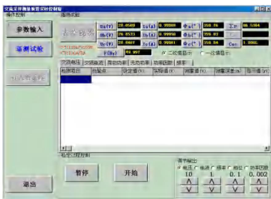
进入上屏后，装置会自动升起一定幅度的电量，使被校设备带电运行预热。之后，按“开始”按钮，装置会依次出现电压、电流、有功功率、无功功率、功率因数、频率、远传数据比对各检定点测量值和后台值输入窗，如下图（图 8.1.4）：
