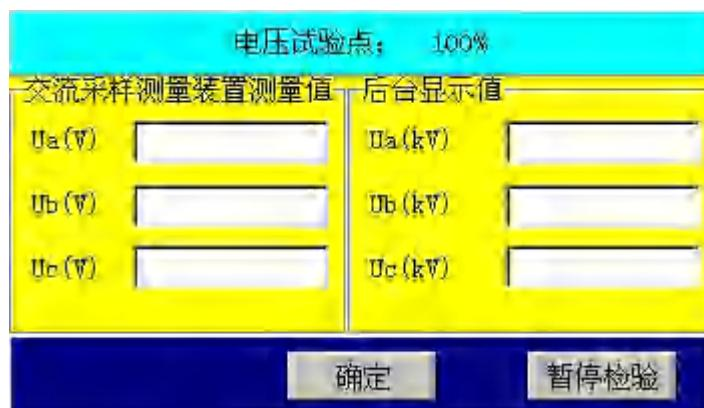
在上屏中输入读取的被校采样装置的测量值和后台显示值（理论上为二次值乘变比）后，按“确定”按钮，装置会自动进行下一个试验点的校验，校验过程中，按图 8.1.3 所示屏中参数键按钮，可实时查看校验结果，比如，按“交流电压”按钮，即可查看电压测量的校验结果，直到完毕。所有的项目校验完后，系统会自动弹出一个小小的提示窗“试验项目检验完毕，可以存入数据库”，按“确认”按钮，再按图 8.1.0 所示屏中的“存入数据库”按钮，依照系统的提示，直到将检验数据存入数据库。
