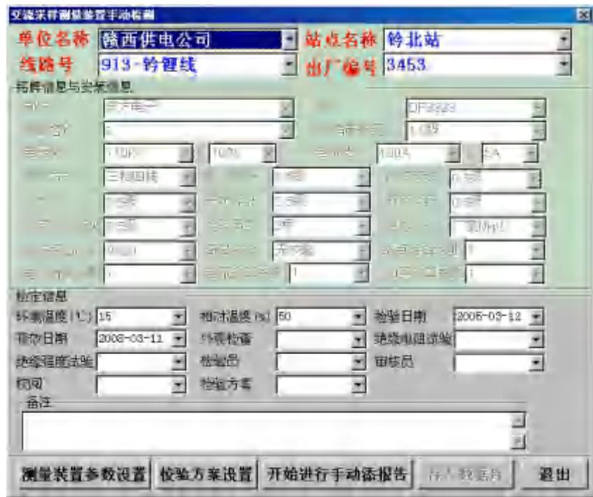
根据检测记录，按上图中的“测量装置参数设置”按钮，可输入各参数；按“校验方案设置”按钮，将当前的检定点设定为“方案 1”（假设检验方案选定“方案 1”，设置的方案应与你检验方案的选定相一致）；按“开始进行手动添报告”按钮，则会弹出一个测量值输入窗（图 8.1.4），这时，将记录的检定数据输入对应框，按“确定”按钮，则进入下一个检定点，同样的操作，直到结束。系统会提示数据保存操作。一组数据完后，“开始进行手动添报告”按钮变为“换线路”按钮，提示进行下一组数据的输入。
