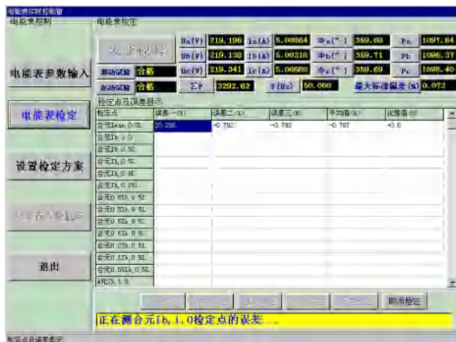
当电量稳定下来后，并达到“校验圈数”后，系统会自动保存当前检定点的“误差一(%)”、“误差二(%)”，“误差三(%)”及“误差二(%)”与“误差三(%)”的“平均值(%)”和“化整值(%)”。如此，直到所有检定点都检定完毕，系统会自动清电量，关功放，如下图所示：
