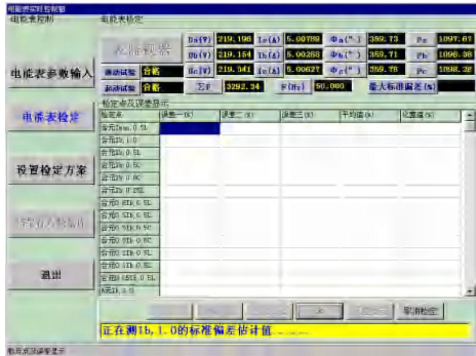
系统会自动测量“ $I_b, 1.0$ ”、“ $I_b, 0.5L$ ”、“ $0.5I_b, 1.0$ ”及“ $0.5I_b, 0.5L$ ”四个试验点的标准偏差估计值，并显示“最大标准偏差(%)”。
