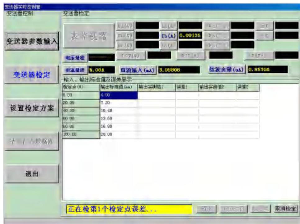
系统会自动判断某一检定点处电量是否稳定下来，如果稳定下来后，后自动保存当前“输出实测值”及“误差”。如此，直到所有检定点都检定完毕，系统会自动清电量，关功放，如下图所示：
