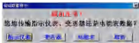
此时校验仪已将控制权交给了计算机控制系统；现在可以在微机上传输指示仪表、电能表或变送器的检定数据了。
