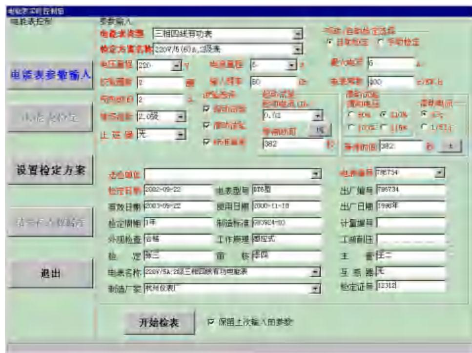
最后只要点按“开始检表”按钮，则系统会自动将所输入的参数发送给校验装置，控制命令传输几秒钟后，系统自动会进入“电能表检定”窗。
