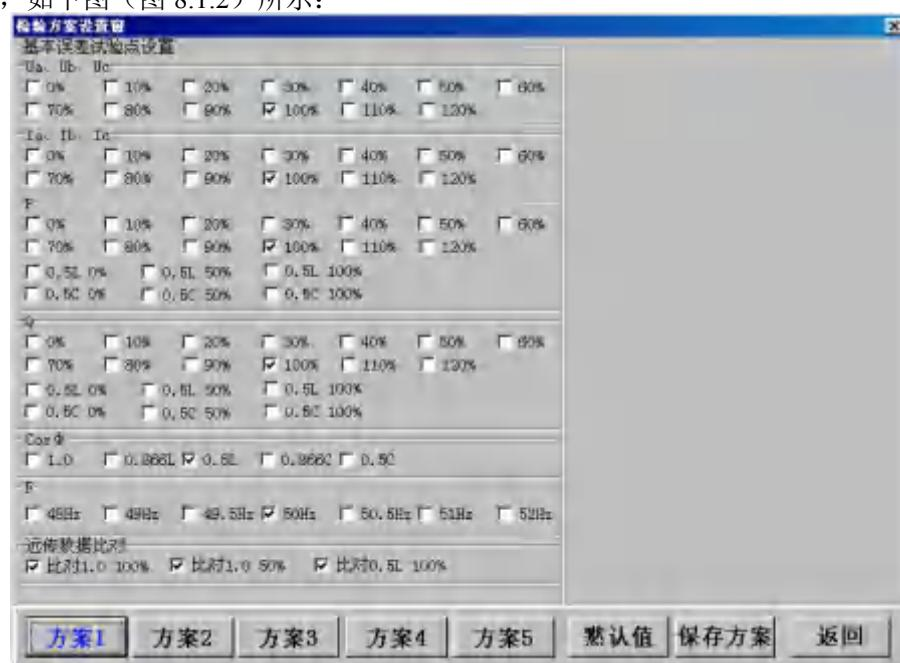
在上屏中，可依次对电压、电流、有功功率、无功功率、功率因数、频率、远传数据比对的各检定点进行设置。按“默认值”按钮，界面中打“√”的为“默认值”校验点，如无需修改或添加，可按“保存方案”；如需修改或添加，则按要求选择好各校验点后，再按“保存方案”按钮。在本界面中，除默认方案外，还可设置并保存五种常用方案。如先按“方案 1”按钮，然后选定的需要校验点，再按“保存方案”按钮，即设定好了“方案 1”，当下次使用本方案时，只需在 8.1.0 屏中的校验方式中选定“方案 1”即可。同样的方法可设置“方案 2”，直到“方案 5”。
