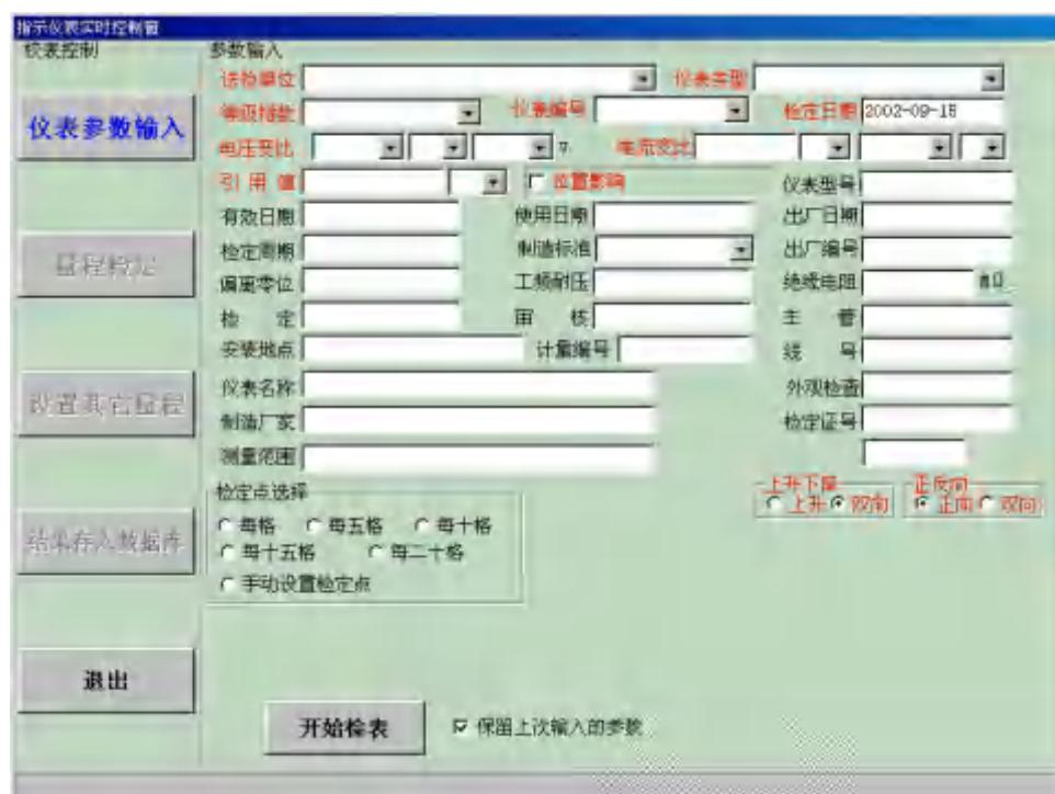
进入“指示仪表实时控制窗”后，在检表之前，系统要求输入与仪表相关的各种参数，在此窗体中，标签显示为红色的输入框必须输入，检表操作才可进行，如“送检单位”、“仪表类型”、“等级指数”、“仪表编号”、“检定日期”、“引用值（即最大格度值）”等。在此窗体在，有些输入框只有当选择某些特定的仪表类型后才会出现，如“功率因数点”只有在“仪表类型”为功率表时才出现；“频率最小值”只有在“仪表类型”为“工频频率表”时才出现。
