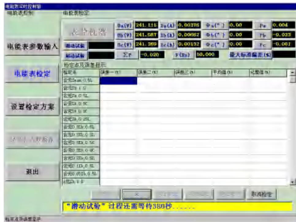
当达到“潜动试验”等待时间后,或点按原“潜动试验”按钮所在位置处的“ $\times$ ”按钮中止潜动试验过程,系统会自动判断“潜动试验”是否合格,并自动进行“起动试验”(如果“电能表参数”输入窗中的“试验选择”框中的“起动试验”前打“ $\checkmark$ ”),如下图所示:
