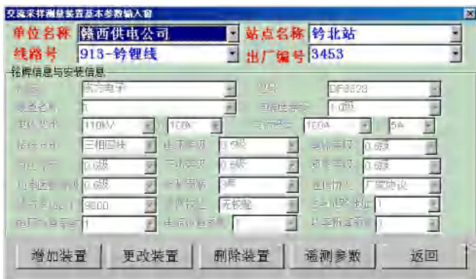
在上屏中，可增加或更改各个参数；按“遥测参数”按钮（或是在图 8.1.0 所示屏中按“遥测参数设置”按钮），系统都会弹出一个“RTU 遥测参数输入窗”，用于交流采样测量装置的自动校验；“按“返回”按钮，返回上一屏，即图 8.1.0 所示屏。
