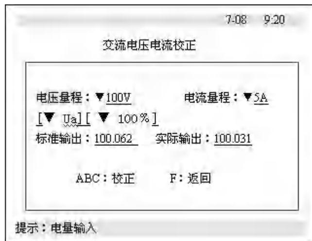
在上一屏的下拉提示前，可依次作电压基本量程（或电流基本量程）、校正相别（如选 Ua，表示作电压 A 相校正）、校正点（其中 Ks 是指满度调节，其余的为线性调节点。校正时，应按照从上至下的顺序，依次逐点校正。）
