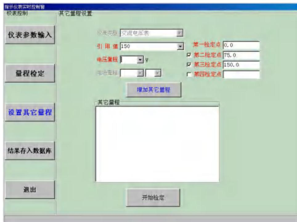
输入相应的电压电流量程，点按“增加”按钮，系统会将其显示在“其它量程”显示框中，如下图所示：
