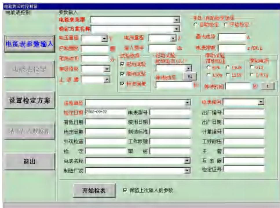
在窗体左边部分可以控制显示电能表实时控制中所要操作的窗体，当前显示的窗体会以**兰色加粗字体**显示，例如当前正处于“电能表参数输入”窗中（系统进入电能表实时控制时的默认状态）。其它还有“电能表检定”和“设置检定方案”窗会在下面的章节中详细说明。
