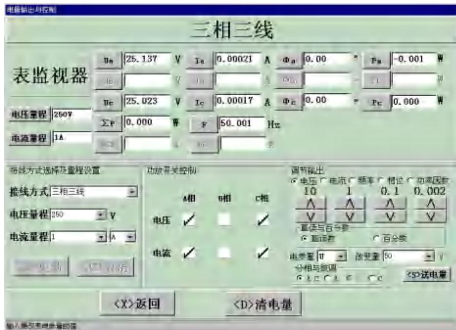
只要点按“送电量”按钮，则会将改变量中输入的值更新到校验装置中，并显示在“表监视器”中，如下图所示：
