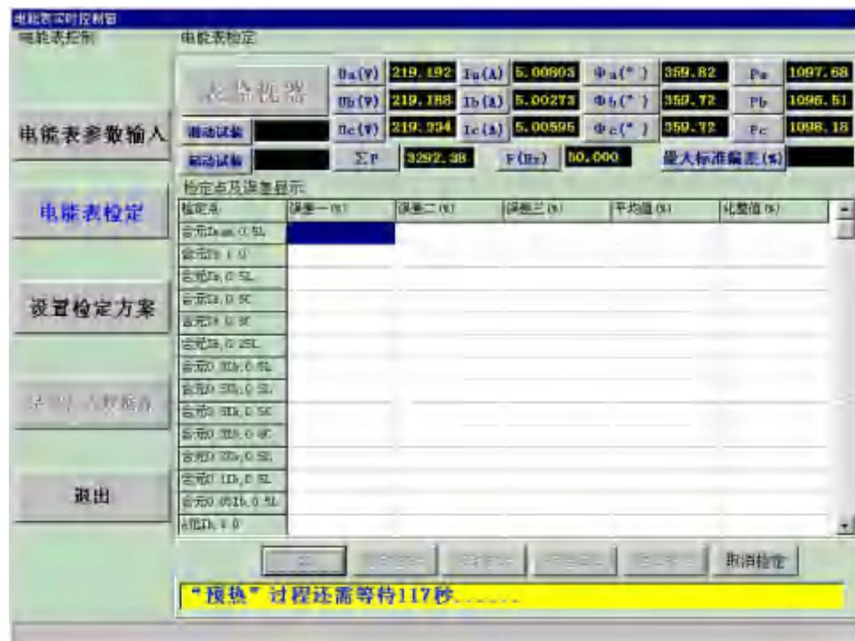
当达到“预热”过程的预热时间后，或点按原“预热”按钮所在位置处的“ $\times$ ”按钮中止预热过程，系统会自动进行“潜动试验”（如果“电能表参数”输入窗中的“试验选择”框中的“潜动试验”前打“ $\checkmark$ ”），如下图所示：
