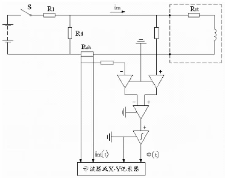
图 E.0.2-3 直流法基本电路
