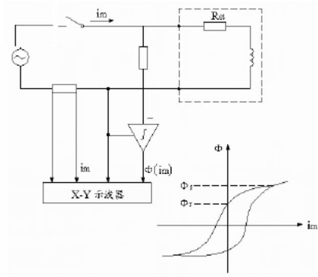
图 E.0.2-2 用磁滞回环确定剩磁系数  $K_t$
