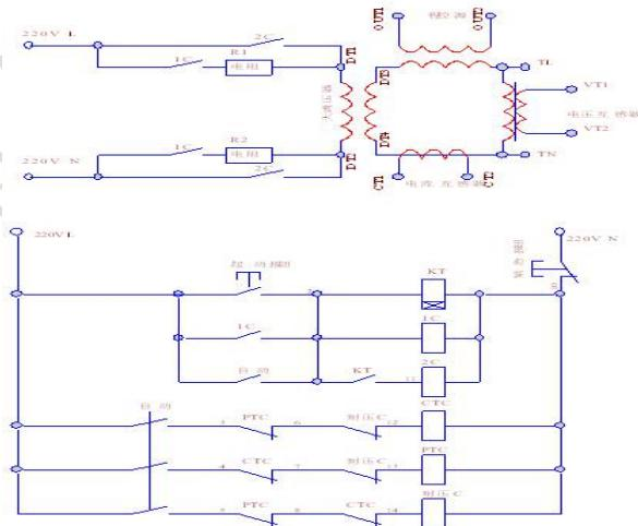
如上图：控制柜通电后按下启动按钮的蓝色指示灯亮，表明控制柜已上电，通过校验仪选择测量对象，使相应的接触器吸合，使相应的输出端有电压输出，当出现异常情况时，可将停止按钮按下使台体断开输出。
