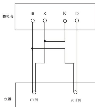
检定时可以使用互感器整检台，选择电压互感器测量回路即可。注意请选择“不带自校”，
