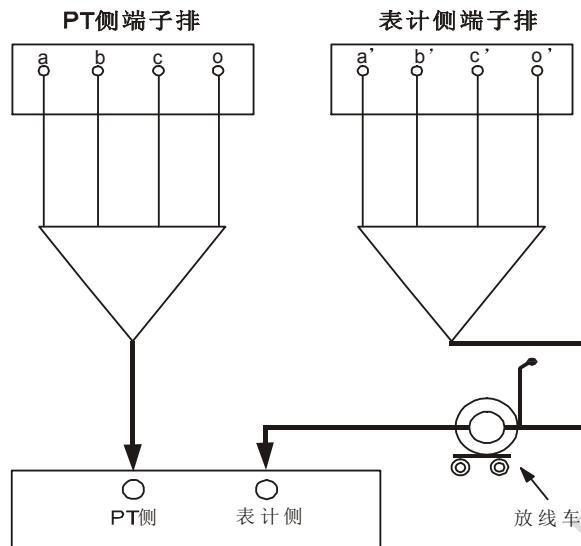
①开机按“确定”键入主菜单，选择压降测试菜单，进入后选择测试方式（有PT侧和表计侧，选择方法是光标移动到要选择的内容，按确定键后在下拉列表中按上下键移动光标，确定键选择），自校状态（带自校和不带自校）选择将决定仪器是否减去自校时测试的现场误差值。输入各相参数。
