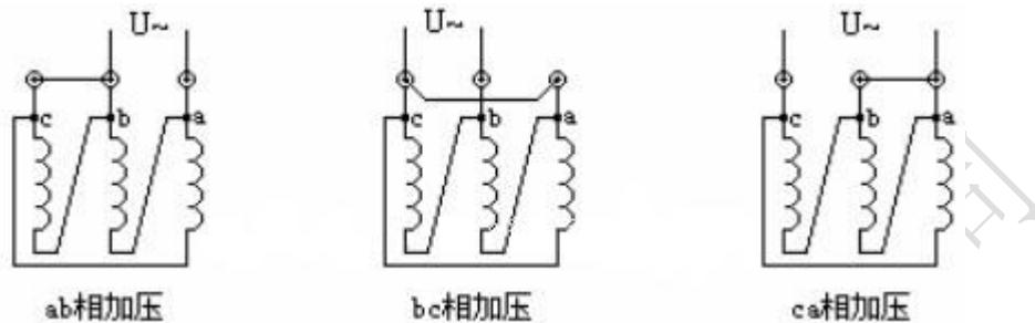
图十九 加压绕组为 $\Delta$ 型连接的接线示意图
