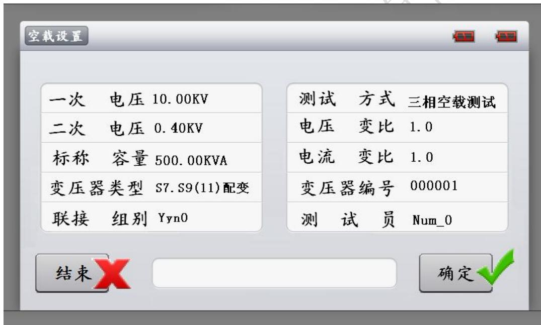
图五 空载测试参数设置界面
