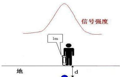
首先用接收机对目标管线峰值和峰谷响应作定点定位。如果两个位置不一致，则表示有干扰存在，重新施加发射机信号清除不需要的信号后再试一次，在两个信号响应一致的地方进行深度测量。测量埋深时，将接收机放在管线正上方，机身面与管线成直角并与地面垂直，且贴近地面。
