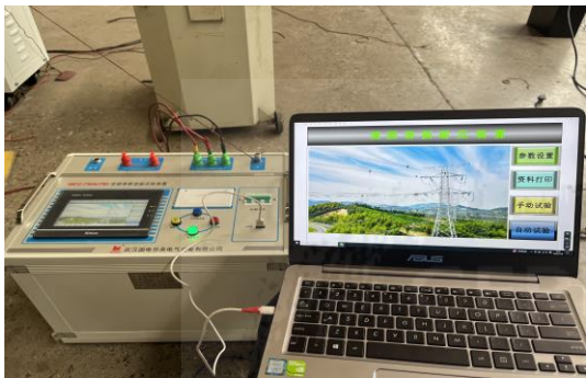
照片24就地和远动电压自动升、降和自动计时功能检查
